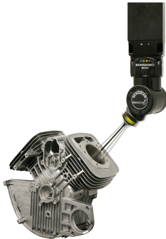
5-axlig skanningsteknologi revolutionerar CMM-kontroller.
