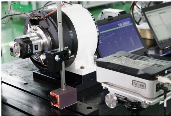
리니어 모터 및 로터리 테이블 검사에 Renishaw의 XL-80 간섭계와 XR20-W 로터리 축 캘리브레이터를 사용하고 있는 Haozhi
